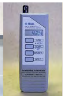
Thermohygromètre : mesures ponctuelles
