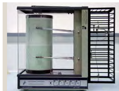
Thermohygrographe : mesures en continu de la température et de l'humidité relative
